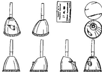
con Contenedor de Cartuchos de Tinta. Una Pluma Fuente con Contenedor para Cartucho de Tinta, cuyo contenedor esta construido por un cuerpo de forma general cuasi cónica truncada oblicua de treinta y ocho unidades arbitrarias de diámetro en la base, quince unidades arbitrarias de diámetro superior y treinta y un unidades arbitrarias de altura. El
